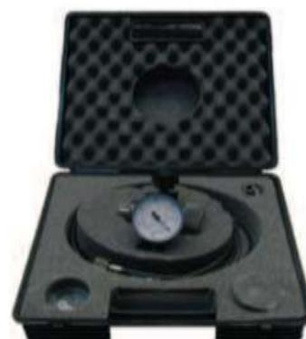
El dispositivo de precarga "AR" es un instrumento indispensable para el llenado y control de nitrógeno de los acumuladores. Fabricado en acero al carbono zincado puede ser utilizado hasta 330 bar
